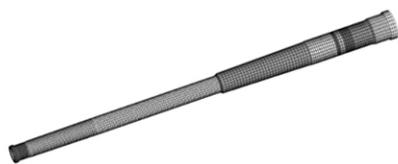
图4 身管刚度有限元模型图
