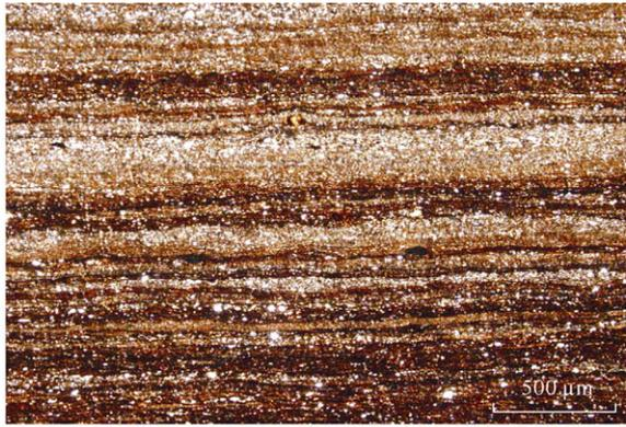
(a) 里147井, 2 422 m, 黑色页岩, 发育碳酸盐-石英-长石-黏土矿物-有机质-黄铁矿“三元”纹层结构, 见纹层间微裂缝, 单偏光照片
