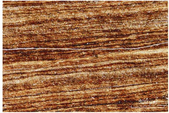
(b) 白32井, 2 458.8 m, 黑色页岩, 发育碳酸盐-石英-长石-黏土矿物-有机质-黄铁矿“三元”纹层结构, 见斜交微裂缝, 单偏光照片
