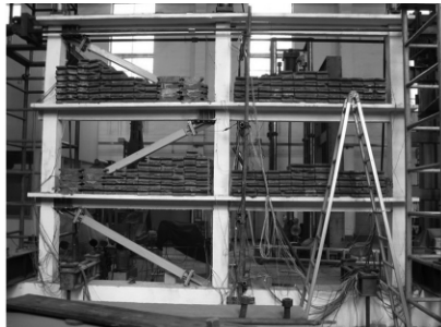
图 5 模型加载及测点布置照片
